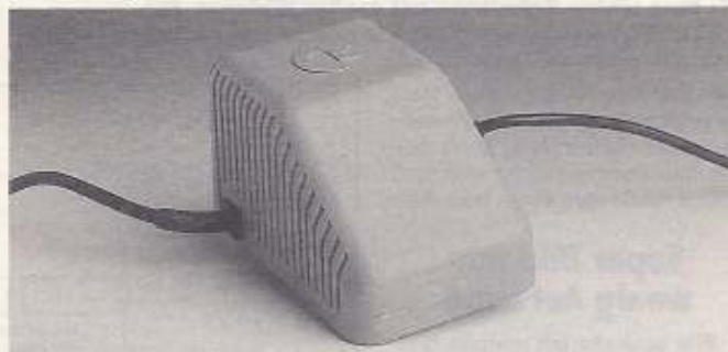
1 Das Netzteil des C64 gibt, wie unsere Leserumfrage erwiesen hat, oft seinen Geist auf. Mit unserem neuen Netzteil hat das alte endgültig ausgedient.
